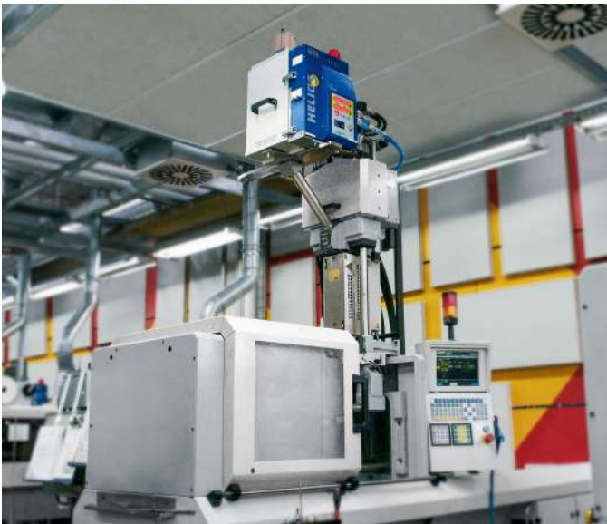
20 Liter auf vertikaler Spritzeinheit
